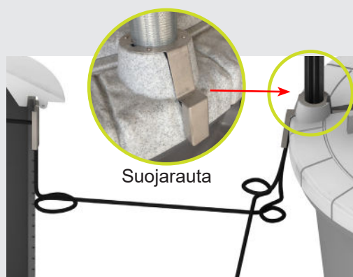
Kuva 10: Maakaapeli ja suojarauta
